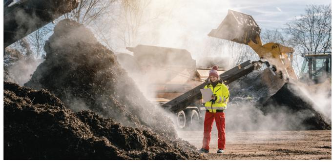
El material se coloca en grandes montones, donde los microorganismos comienzan a descomponerlo y a calentar los montones a temperaturas muy altas.
