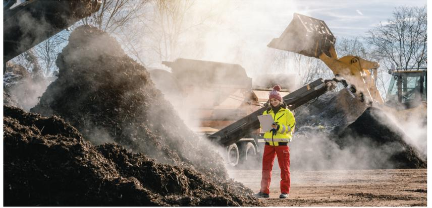
El material se coloca en grandes pilas, donde los microorganismos comienzan a descomponerlo y a calentar las pilas a temperaturas muy altas.
